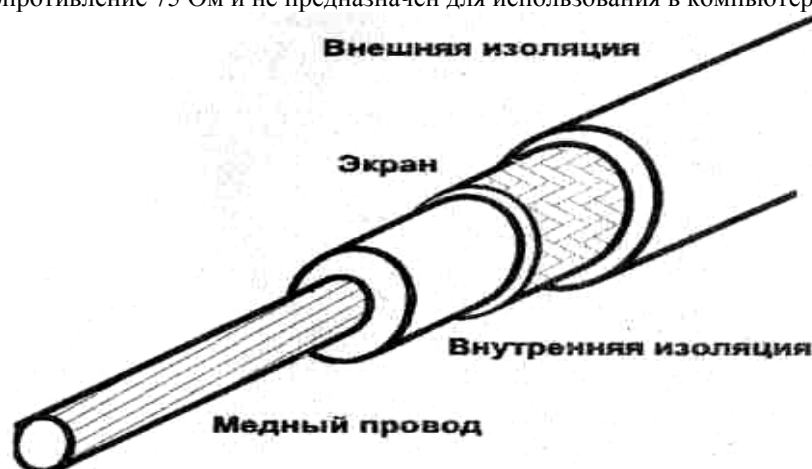
Рис. Коаксиальный кабель (схема).
